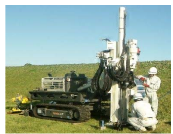
車両質量 3,000kg タイプの自走式専用貫入車を使用した場合
