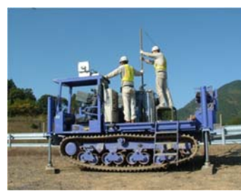
車両質量 9,000kg タイプの自走式専用貫入車を使用した場合
