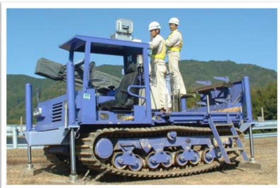
専用貫入車（車両質量 9,000kg）
