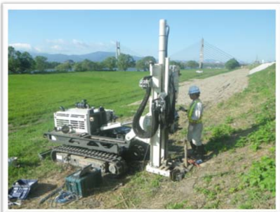
専用貫入車（車両質量 3,000kg）
