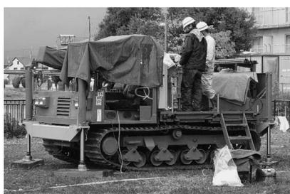
写真—4.1 貫入装置の例 (自重タイプ: 自重90 kN)
