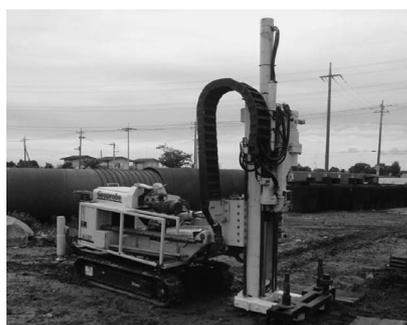
写真—4.2 貫入装置の例 (アンカータイプ: 自重22 kN)
