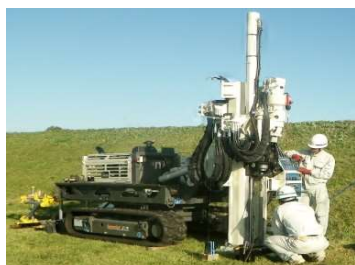
車両質量 2,800kg タイプの自走式専用貫入車を使用した場合
